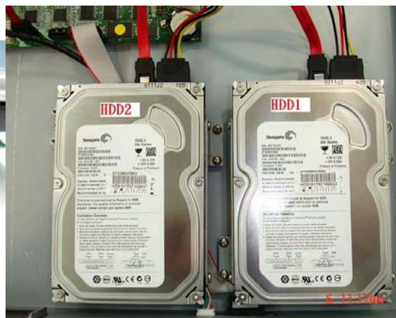
Fixez le(s) disque(s) dur à l'enregistreur (Illustration 5)
