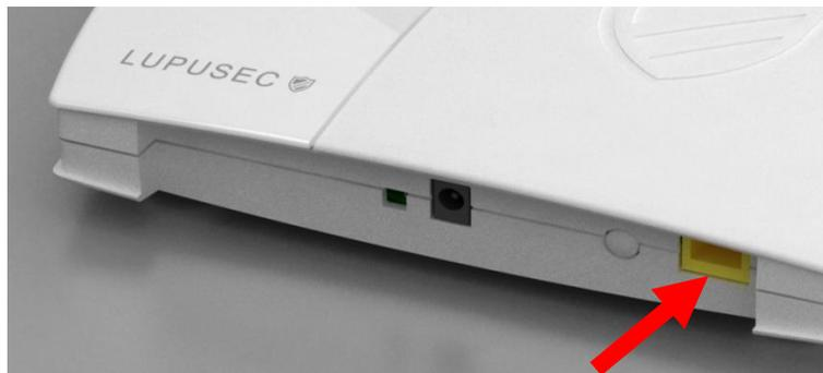
**Hinweis:** Die Alarmzentrale besitzt keine WLAN- Verbindung und muss immer mit einem LAN-Kabel angeschlossen werden wenn Sie über Netzwerk darauf zugreifen möchten.
