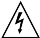
Dieses Symbol soll den Benutzer auf möglicherweise ungeschützte gefährliche Spannungen innerhalb des Gehäuses hinweisen. Diese können unter Umständen einen elektrischen Schlag auslösen.
