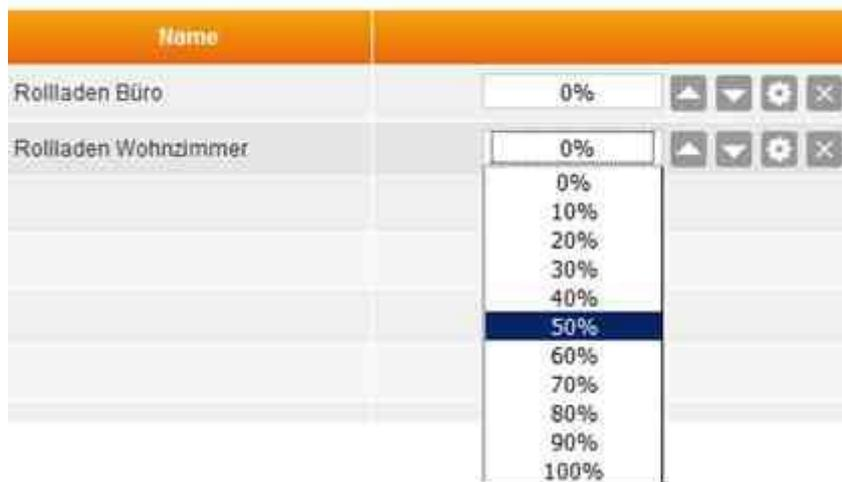
Im Menü „Home“ → „Übersicht“ können Sie mit eingetragener „Zeit zum Hochfahren“ bzw. „Zeit zum Runterfahren“ (Sensor editieren) per Dropdownmenü wählen auf welche Höhe der Rollladen fahren soll. 0% wäre ein geschlossener Rollladen (in der App den Slider nach rechts), 100% ein komplett geöffneter Rollladen (in der App den Slider nach links).
