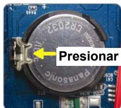
Paso 5: Coloque la nueva batería en el panel principal con el lado "CR2032" hacia arriba.
