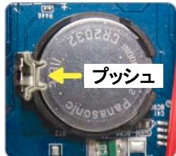
ステップ 5：新しいバッテリの「CR2032」を上に向けて、メインボードに取り付けます。
