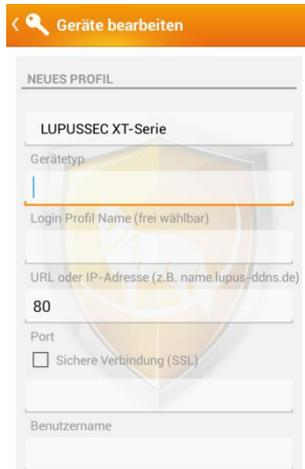
Wählen Sie zuerst durch antippen auf den „Gerätetyp“ aus, ob Sie ein Produkt aus der „Lupusec XT-Serie“ (Alarmanlage) oder „Lupustec Recorder“ (Rekorder) einrichten möchten.
