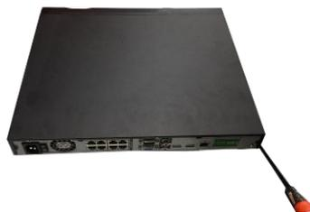
**7.** Schließen Sie das Gehäuse (erst vorne einschieben)
