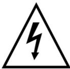
Dieses Symbol soll den Benutzer auf möglicherweise ungeschützte gefährliche Spannungen innerhalb des Gehäuses hinweisen. Diese können unter Umständen stark genug sein, um einen elektrischen Schlag hervorzurufen.
