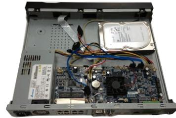
**1.** Lösen Sie alle hinteren Schrauben
