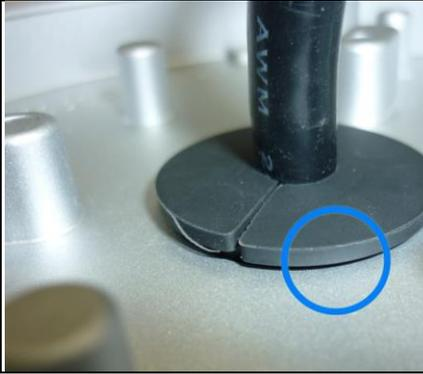
Kabel durch das Wasserdichte Verbindungsstück und durch das der Montagebox. Verbinden Sie die Kamera mit dem externen Kabel.
