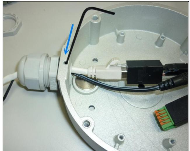
8. Fixieren Sie den Boden der Montagebox an einer Wand oder Decke. Wenn Sie Schrauben nutzen, achten Sie darauf, dass ein Dichtungsring dazwischen ist und die Schrauben fest verdreht sind.
