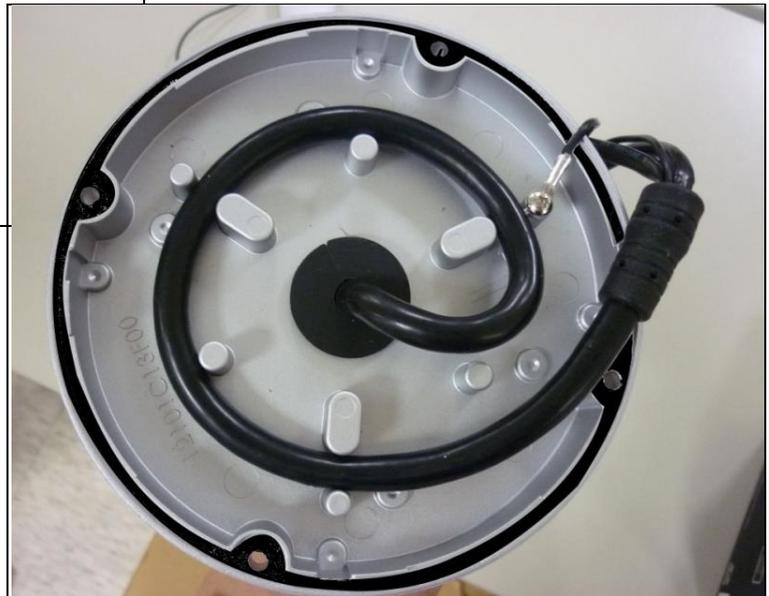
11. Bevor Sie die Box verschließen, stellen Sie sicher, dass der Gummiring am Rande und der Metalldeckel fest sitzen.
