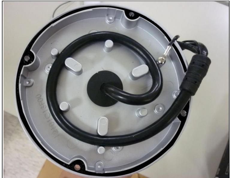
11. Prenez le couvercle de la boîte avec des câbles enroulés et le couvrir sur le fond de la boîte. Avant de fermer la boîte, assurez-vous que l'anneau en caoutchouc noir sur la frange du couvercle est plat et colle complètement sur le couvercle.
