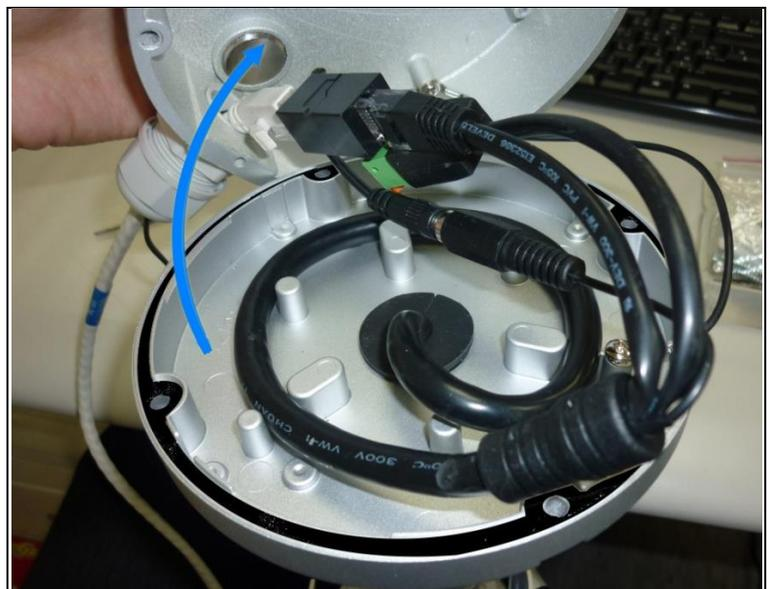
12. Enfin, bloquer les vis sur le couvercle, et ne laisser aucun espace entre le couvercle et le fond de la boîte. Finitions d'installation.
