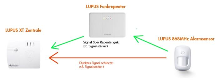
An der Zentrale kommen <u>zwei</u> Signal an – das direkte Signal mit Stärke 3 und das Signal über Repeater mit Stärke 9. Die XT zeigt das <u>erste</u> ankommende Signal an. Dies ist in der Regel das direkte Signal.
