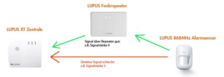
An der Zentrale kommen <u>zwei</u> Signal an – das direkte Signal mit Stärke 3 und das Signal über Repeater mit Stärke 9. Die XT zeigt das <u>erste</u> ankommende Signal an. Dies ist in der Regel das direkte Signal.
