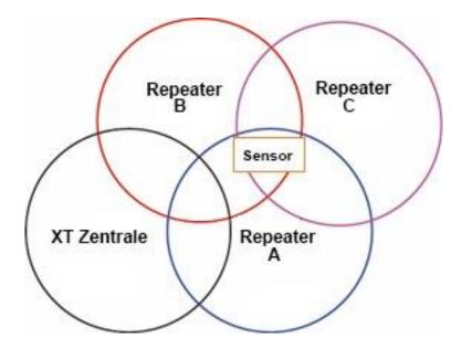
In diesem Beispiel hat der Sensor dieselbe Reichweite zu Funkrepeater A, B und C. Der Sensor sollte an Funkrepeater A oder B angelernt werden, da diese sich am nächsten zur Zentrale befinden.
