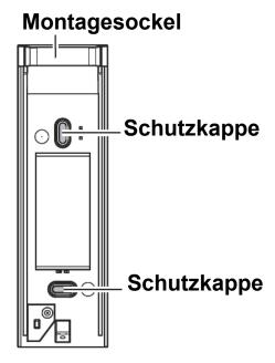
**3.** Schrauben Sie den Montagesockel in einer Höhe von 0,8 – 1,2 Meter über dem Boden fest. Der Melder sollte immer vertikal ausgerichtet werden. Befestigen Sie anschließend wieder den Sensor am Montagesockel.
