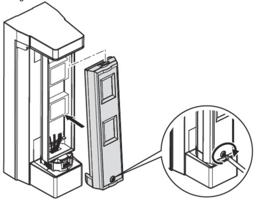
**6.** Heben Sie mit Hilfe eines Schlitzschraubenziehers, die Fixierung des Outdoor Bewegungsmelder an, um die Ausrichtung des Blickfeldes vorzunehmen. Befestigen Sie anschließend wieder die Fixierung.
