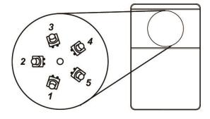
Jede LED überträgt das Signal kegelförmig in die Richtung der Stellung der LED. Die zentrale LED
