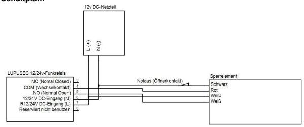
Verkabeln Sie die drei Komponenten nach dem Schaltplan. Wir empfehlenm einen zusätzlichen Not-Aus-Schalter (nicht im Lieferumfang) zu installieren, damit man das Sperrelement per Bedienung des Schalters aufsperren kann, um die Tür zu öffnen. Zur Verkabelung ist es hilfreich, WAGO- oder Lüster- Klemmen zu verwenden (nicht im Lieferumfang).
