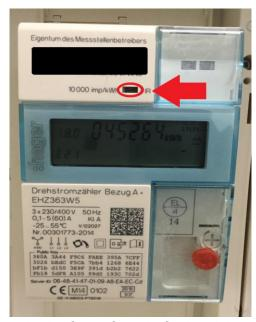
1. Im Lieferumfang befindet sich eine Unterlegscheibe mit doppelseitigem Klebeband. Kleben Sie die Unterlegscheibe über die IR Schnittstelle (LED-Port) des Zählers, so dass die Öffnung der IR Schnittstelle frei bleibt.
