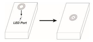
2. Der IR Sensor des Hauptstromzählers hat einen Magnet. Befestigen Sie den Sensor so auf der Unterlegscheibe, dass er freien Zugang zur IR Schnittstelle Ihres Zählers erhält.
