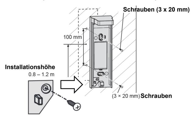
**4.** Verwenden Sie optional dieses Schraubenloch beim Montieren des Montagesockels. Wenn der PIR-Sensor jetzt gewaltsam von der Wand entfernt wird, wird die Sollbruchstelle zerbrochen, das Kunststoffteil verbleibt an der Wand und der der Sabotagekontakt wird aktiviert.
