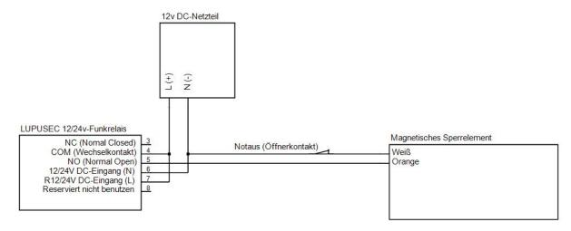
Verkabeln Sie die drei Komponenten nach dem Schaltplan. Wir empfehlen, einen zusätzlichen Not-Aus-Schalter (nicht im Lieferumfang) zu installieren, damit man das Sperrelement per Bedienung des Schalters aufsperren kann, um die Tür zu öffnen. Zur Verkabelung ist es hilfreich WAGO- oder Lüster- Klemmen zu verwenden (nicht im Lieferumfang).
