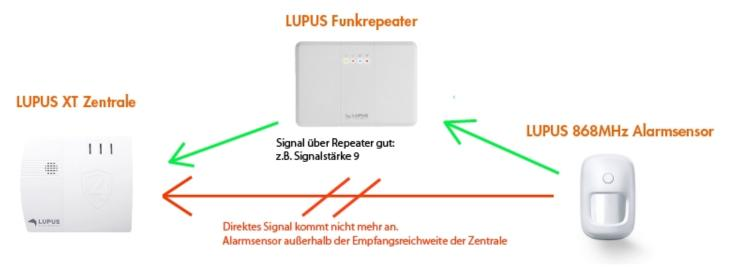
An der Zentrale kommt <u>ein</u> Signal an – das Signal über Repeater mit Stärke 9. Die XT zeigt das <u>erste</u> ankommende Signal an. In diesem Fall, dass Signal über den Repeater.
