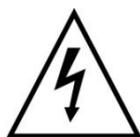
Dieses Symbol soll den Benutzer auf möglicherweise ungeschützte gefährliche Spannungen innerhalb des Gehäuses hinweisen. Diese können unter Umständen einen elektrischen Schlag auslösen.
