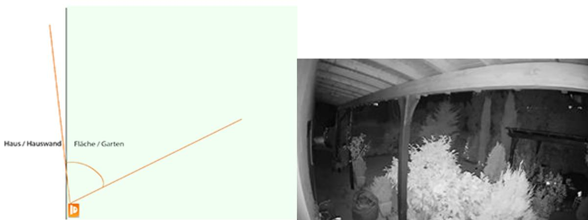
In diesen Bildern sehen Sie, dass die Wand nicht mehr für eine Überbelichtung sorgt – Sie sehen im Vergleich zum ersten Bild den Weg und den Garten. Das Gebüsch und das Vordach sorgen als zu nahe Hindernisse (in diesem Fall unter 2 Meter Abstand) weiterhin dafür, dass die Kamera die IR-LEDs herunterregelt und der Hintergrund daher nicht komplett ausgeleuchtet wird / dunkler erscheint.
