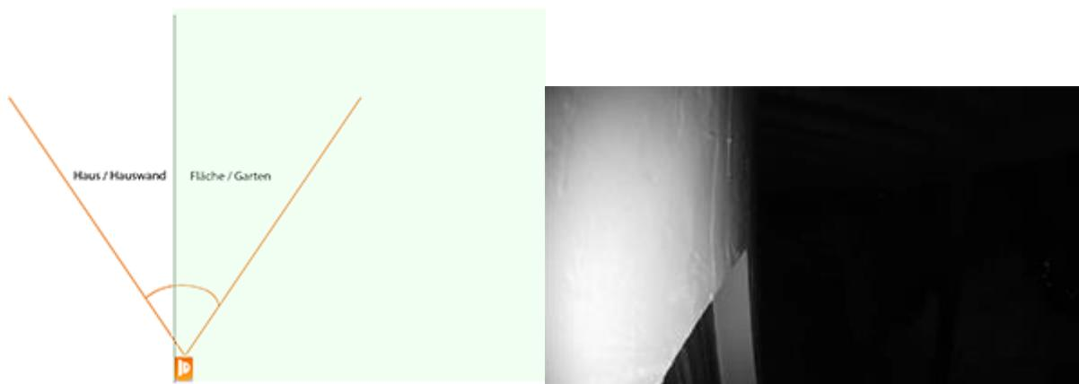
In diesen Bildern sehen Sie, dass die Kamera im 90°-Winkel entlang einer Wand ausgerichtet ist. Dadurch ist die Wand zu etwa 50 % im Fokus der Kamera und reflektiert auf kürzeste Distanz bereits das IR-Licht. Um eine Überbelichtung zu verhindern, regelt die Kamera die Stärke der IR-LEDs automatisch herunter. Dadurch ist die Wand sehr gut zu erkennen, aber im rechten Bereich des Bilds nichts mehr von der Fläche vor der Wand.
