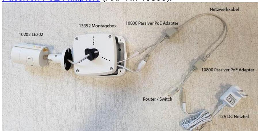
**Hinweis:** Wenn Sie ein Kameramodel mit WLAN-Funktion nutzen und die Kamera erfolgreich mit Ihrem WLAN-Access Point verbunden ist, ist kein Netzwerkkabel mehr erforderlich.
