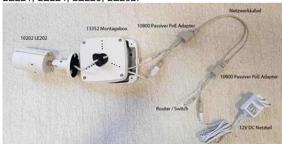
**Variante 3:** Stromversorgung über ein [PoE-Switch](#) über das Netzwerkkabel. Geeignet für LE221, LE224, LE 228, LE232.
