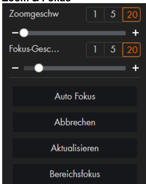
Klicken Sie auf Zoom & Fokus in der unteren linken Ecke der Live-Seite, um die Brennweite anzupassen und das Videobild zu vergrößern oder zu verkleinern. Durch manuelles oder automatisches Anpassen des Fokus oder innerhalb eines bestimmten Bereichs können Sie die Bildschärfe verändern oder Einstellfehler korrigieren. Der Fokus wird nach dem Vergrößern oder Verkleinern automatisch angepasst.
