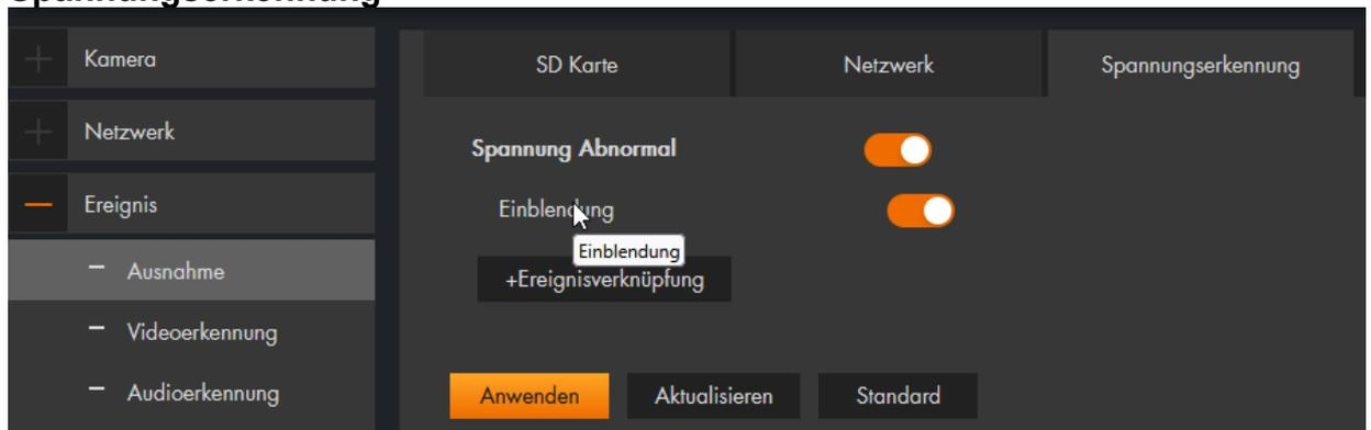
Wenn die Eingangsspannung höher oder niedriger als der Nennwert der Kamera ist, kann ein Warnsymbol im Kamera Menü mit „Einblendung“ angezeigt werden und eine Mail verschickt werden.
