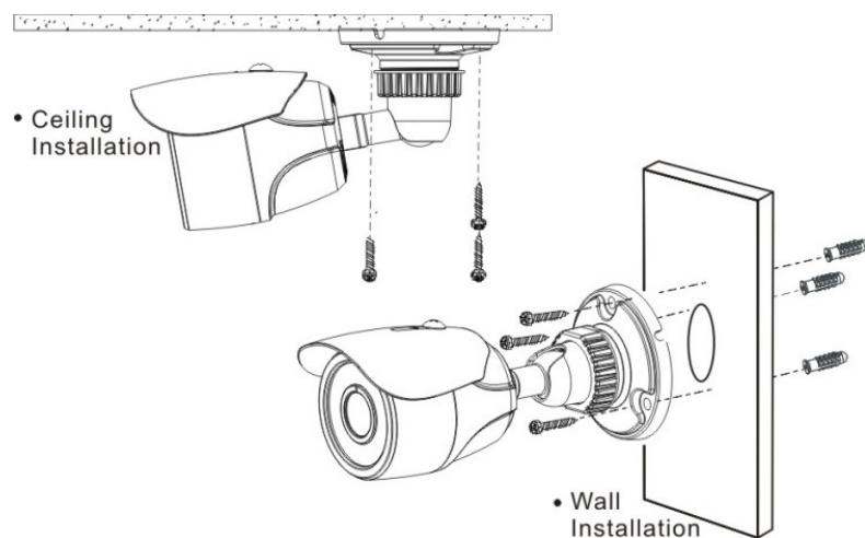
**Hinweis :** Achten Sie darauf, dass der Fuß gut mit der Oberfläche abschließt, so dass sich kein Wasser im Fuß ansammeln kann.
