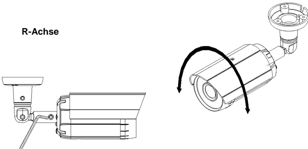
Das Drei-Achsen-Design ermöglicht eine 90° Seitenansicht bei Wand- oder Deckenmontage
