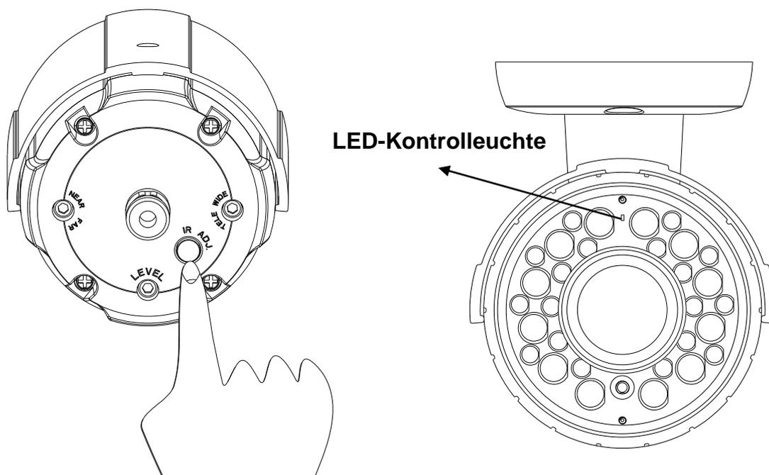
Der LED-Ausleuchtungswinkel muss je nach Blickwinkel der Kamera eingestellt werden. Die folgende Tabelle zeigt Ihnen welche IR-Einstellung empfohlen wird bei entsprechendem Blickwinkel (Fokus).
