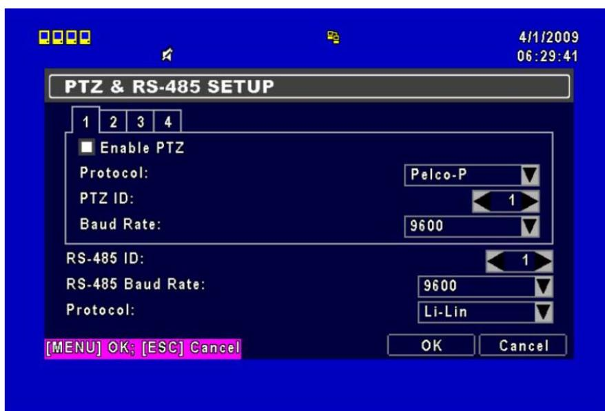
L'enregistreur permet aux utilisateurs de contrôler les fonctions PTZ de vos caméras. Pour permettre à la fonction PTZ, le câble 485 doit être relié au port RS-485 de l'enregistreur.
