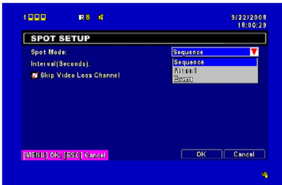
Le DVR possède deux modes de sortie vidéo, l'un est la sortie vidéo principale, et l'autre la sortie vidéo secondaire dite SPOT. La sortie SPOT est configurée pour le contrôle des commandes de chaînes (canaux) que le système gère en cycles en mode SPOT. L'utilisateur peut contrôler tous les canaux dans le mode SPOT.
