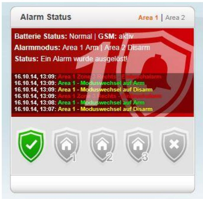
Un error del sistema no ignorado (sensor/contacto de sabotaje activo, batería casi vacía, etc.) se muestra con un signo de exclamación rojo en el fondo.
