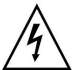
Este símbolo tiene por objeto advertir al usuario de la posible presencia de voltaje peligroso sin aislamiento dentro de la carcasa. Esto puede provocar una descarga eléctrica en determinadas circunstancias.
