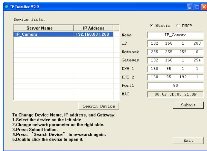
5. IP Installer va rechercher toutes les cameras IP connectés sur le réseau (LAN). L'utilisateur peut cliquer "Search Device" pour effectuer une nouvelle recherche.
